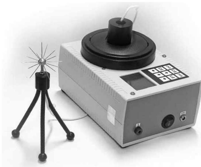
Рис. 5 Прибор «Электрофотонный Датчик» с антенной.
